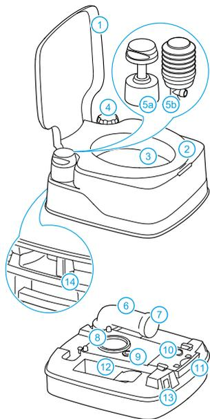
1 Крышка • 2 Сиденье • 3 Унитаз • 4 Крышка водозаливной горловины • 5a Поршневой насос • 5b Сильфонный насос • 6 Сливной патрубок • 7 Заглушка сливной трубы • 8 Прокладка • 9 Уплотнение выпуска воздуха • 10 Кнопка выпуска воздуха • 11 Рукоятка задвижки • 12 Отсек для хранения жидкостей для туалета • 13 Индикатор бачка для стоков (в зависимости от модели) • 14 Зашелка
